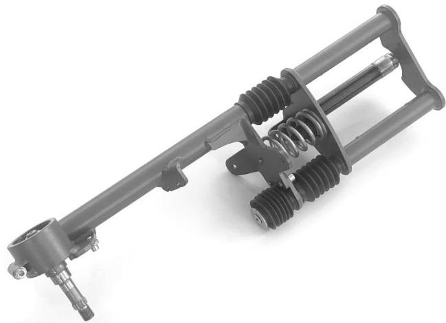
Seit den frühen 90er Jahren sind die Vorderräder der dreirädrigen KYBURZ-Elektrofahrzeuge an Gabeln der Firma EBR montiert. Auf der Homepage der Familienfirma aus der Nähe von Bologna sind unzählige verschiedene Gabeln für kleinere und mittlere Motorräder abgebildet. Auffällig ist: Es sind alles zweiarmige Gabeln! KYBURZ verbaut jedoch seit über einem Jahrzehnt Gabeln mit einem Holmen.
