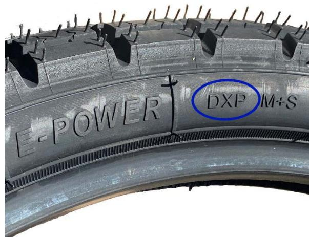
Über Jahre kaufte KYBURZ Reifen auf dem Markt, die ursprünglich für Mofas gefertigt wurden. Mit der Einführung des DXP stiegen die Stückzahlen und die Anforderungen: Schmale Felge, breite Aufstandsfläche, grobes Profil mit Lamellen, verstärkte Flanken, Laufleistung etc. Grosse internationale Reifenfabrikanten winkten ab, sie erachteten den Auftrag als zu unbedeutend.
