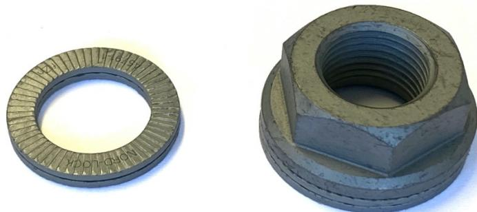
Vibrationen und Schläge wirken besonders bei Fahrzeugen auf geschraubte Verbindungen. Damit sie sich nicht lösen kommen verschiedene Methoden zur Schraubensicherung zum Einsatz: Unterlagsscheiben, Federringe, Sicherungsmuttern, Kontermutter, Klebstoffe (Loctite) oder Keilsicherungsscheiben.
