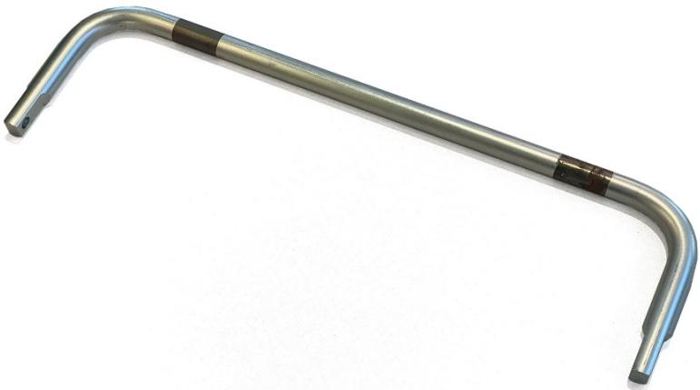
Damit sich die KYBURZ-Fahrzeuge bei Kurvenfahrten nicht zu fest zur Seite neigen, sind sie mit einem Stabilisator ausgerüstet zur Vermeidung dieser sogenannten Wankbewegungen. Das Teil aus gebogenem Rundstahl wirkt auf die oberen Querlenkern der Hinterachse.
